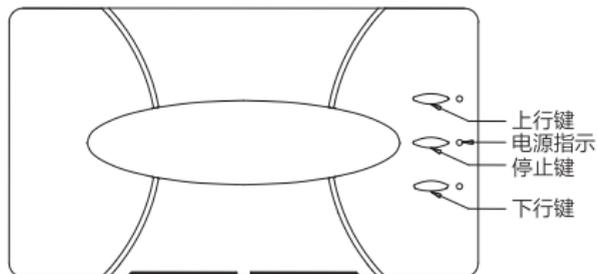
12V电子限位控制器面板示意图 (图4)
